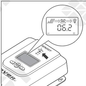
10. チャージコントローラーに正しくバッテリーが接続されると、LCD とバッテリー LED インジケーターが点灯し、電源が入ります。
