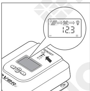
8. ソーラーパネル延長ケーブルをソーラーパネルに接続し、充電を開始するとソーラー LED インジケーターが点灯します。充電を開始するには、ソーラーパネルの電圧が、バッテリーの電圧よりも 2V 以上上回っている必要があります。
