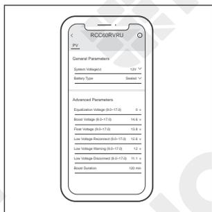
4. このインターフェイスでは、バッテリーの複数のパラメーターをカスタマイズすることができます。パラメーターが変更されると、インターフェイスに「設定完了」と表示され、パラメーターの設定が完了します。
