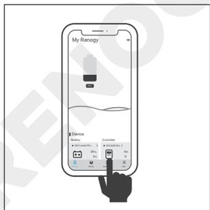
5. チャージコントローラーをタップして、チャージコントローラーのパラメーターを確認します。パラメーターを変更するには、ユーザーマニュアルの「ユーザーモード」を参照してください。
